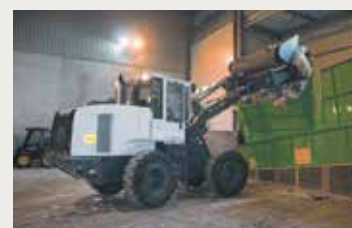
2 Chargement sur la trémie d'alimentation des lignes de tri.
