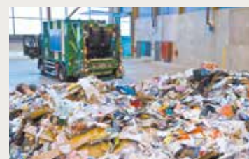
1 Déversement du contenu des bennes de collecte dans la zone de stockage amont.
