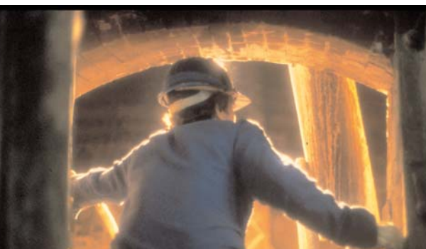
Combustion des déchets dans le four-chaudière
