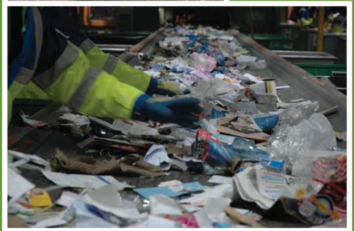
Le centre de traitement des déchets d'Ivry : la fosse de réception des déchets ménagers et la chaîne de tri des emballages à recycler.
