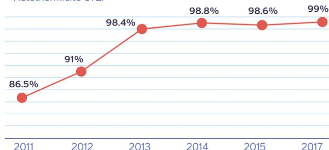
Fig. 1 : Évolution de l'autothermicité de la STEP sur la période 2011 - 2017 - Source : Biovalsan
