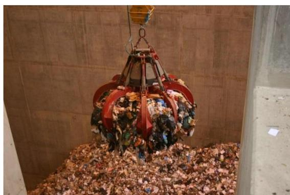
Figure 11: Grappin sur pont-roulant en fosse
