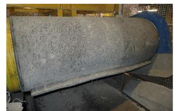
Figure 25 : Photo d'un overband, nouvel élément de captation des ferrailles
