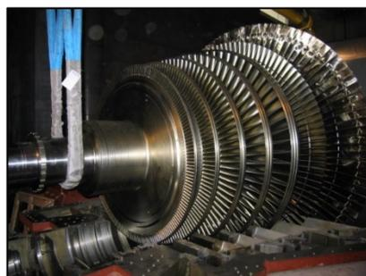
*Figure 11 : Rotor du Groupe Turbo Alternateur (GTA)*
