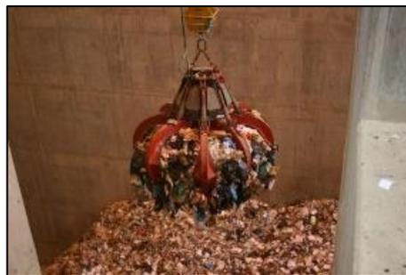
*Figure 10 : Grappin sur pont-roulant en fosse*
