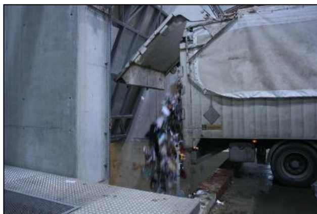
Figure 5 : Déchargement d'ordures ménagères en fosse
