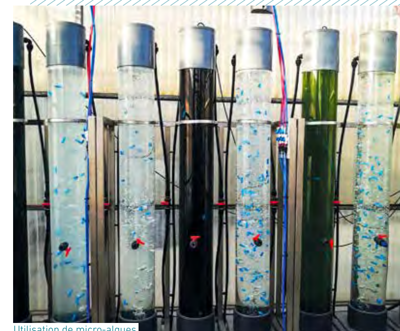
Utilisation de micro-algues pour la captation du CO 2 contenu dans les fumées d'incinération.
