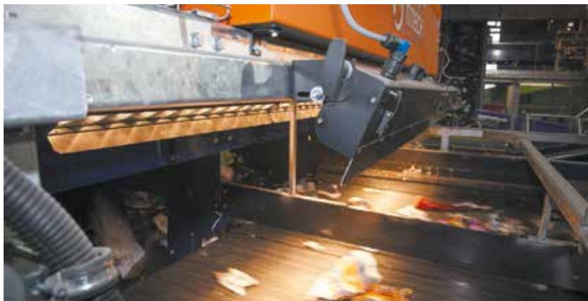
L'un des quatre trieurs optiques installés au centre de Sevrans.
