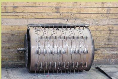
Cylindre d'une ouvreuse de sacs muni de picots
