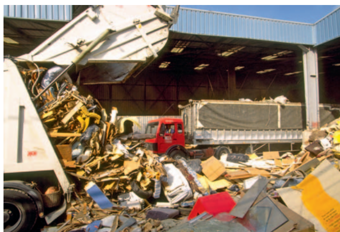
La collecte en benne tasseuse des DEEE endommage les matériaux recyclables.
