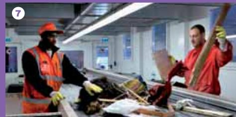
⑦ En cabine, les opérateurs de tri se concentrent sur le contrôle et la rectification des erreurs de tri. Les produits triés sont ensuite stockés avant d'être conditionnés et expédiés vers les filières de reprise.
