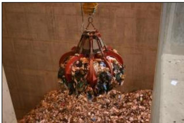
Figure 7 : Grappin sur pont-roulant en fosse
