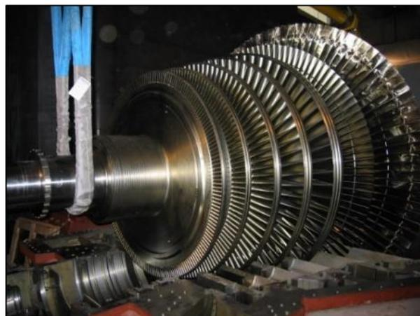
Figure 8 : Rotor du Groupe Turbo Alternateur (GTA)
