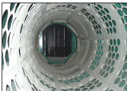
Figure 6 : Photo du trommel de la collecte sélective
