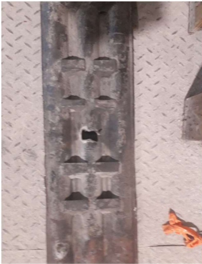
Photo 1: tube percé ayant causé la fuite d'eau
